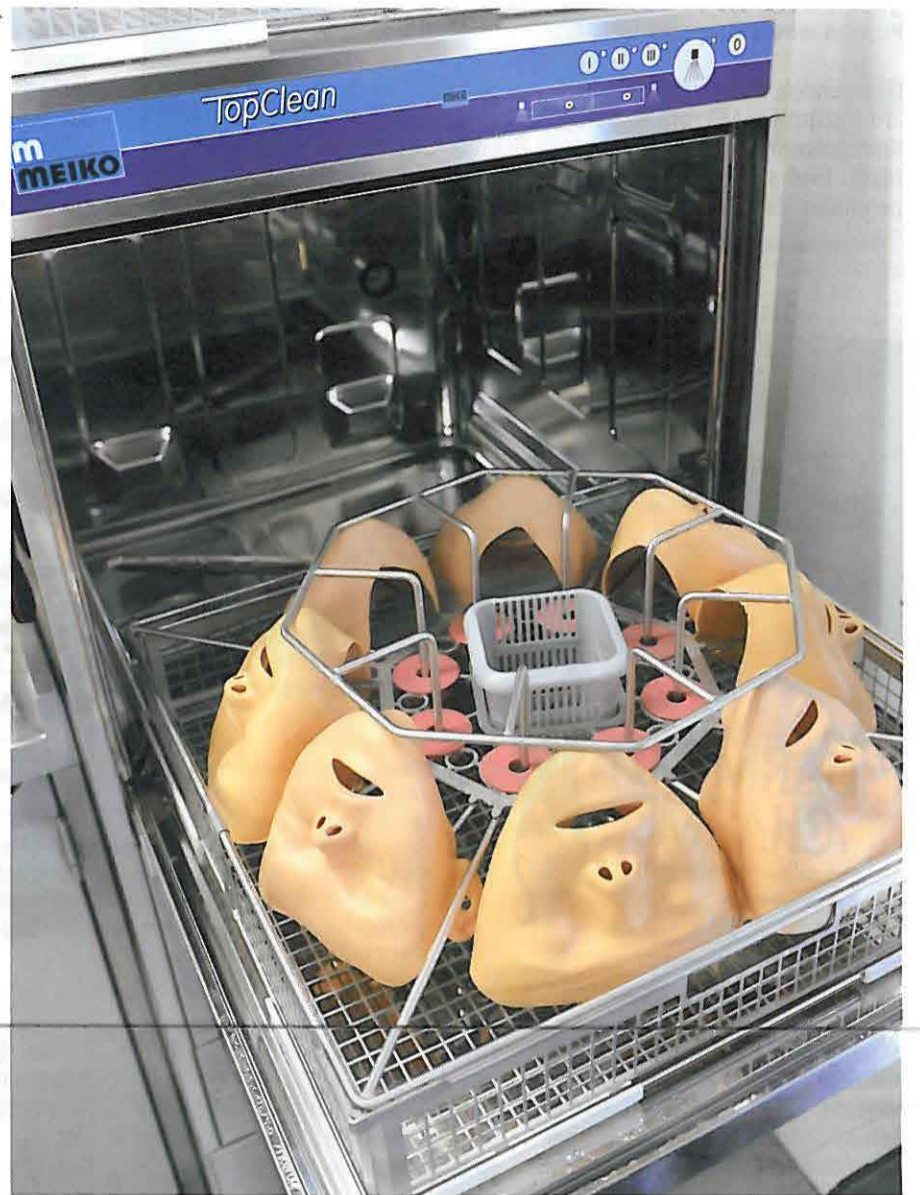
Säuberlich in den eigens von MEIKO entwickelten Korb eingeordnet, werden die Gesichter von Resusci-Anne im Reinigungs- und Desinfektionsgerät in Minutenschnelle aufbereitet. Fotos: Stephan Hund
