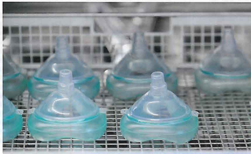
Säuberlich in den eigens von MEIKO entwickelten Korb eingeordnet, werden die Gesichter von Resusci-Anne im Reinigungs- und Desinfektionsgerät in Minutenschnelle aufbereitet. Fotos: Stephan Hund
