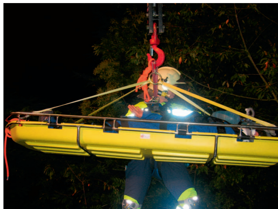
Der Schleifkorb eignet sich vor allem für Bergungen aus schwierigem Gelände. (Bild: Feuerwehr Zofingen)
